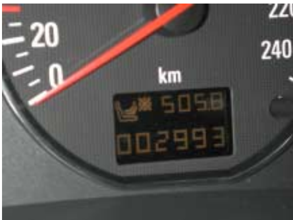
Kuva 10: Matkamittarin yhteydessä sijaitseva poiskytkennän merkkivalo
