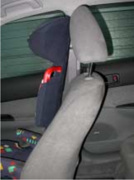
Kuva 3: Lastenistuin törmää ajoneuvon istuimen päätukeen
