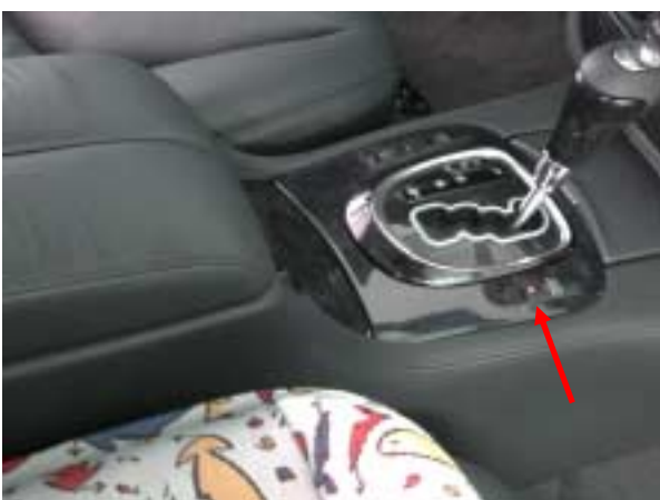
Kuva 7: Toiminnan poiskytkennästä ilmoittava valodiode
