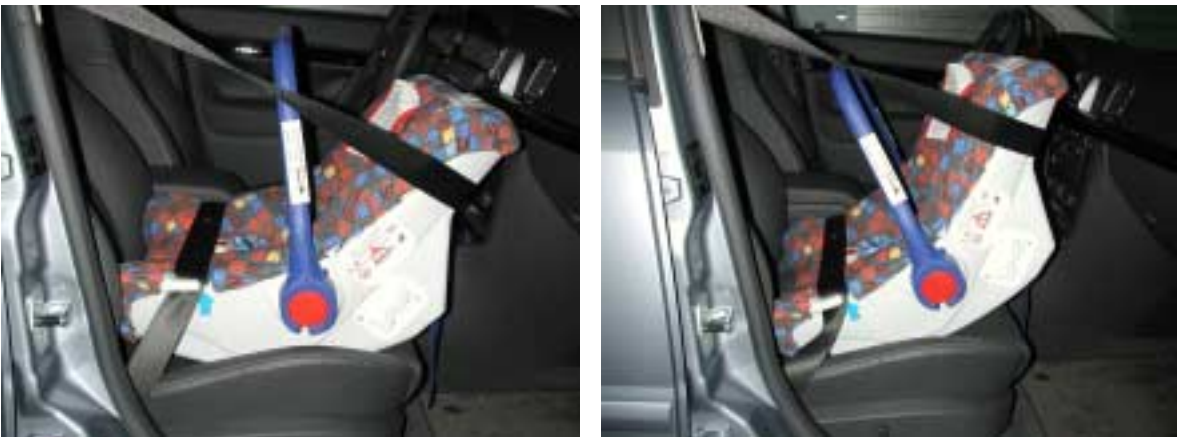
Kuva 13: Vauvan turvaistuimen muodosta johtuva keinumisliike
