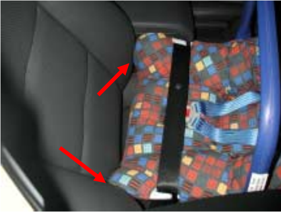
Kuva 12: Lastenistuimen törmääminen istuimen sivuosiin
